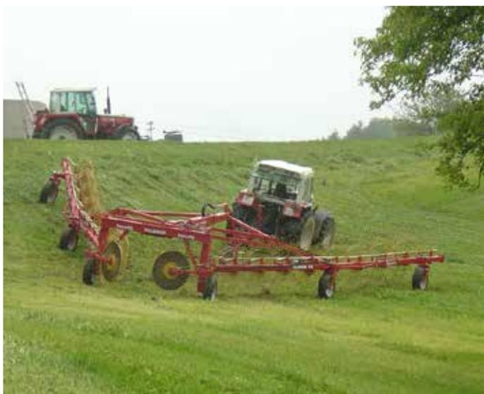
Грабли колесно-пальцевые прицепные серии MILLENNIUM предназначены для сгребания подвяленной и сухой травяной массы, соломы из прокосов в валки заданной ширины, ворошения её в прокосах, оборачивания валков. Обеспечивают высокое качество сбора травы (в том числе люцерны) в рыхлый, нескрученный валок.
